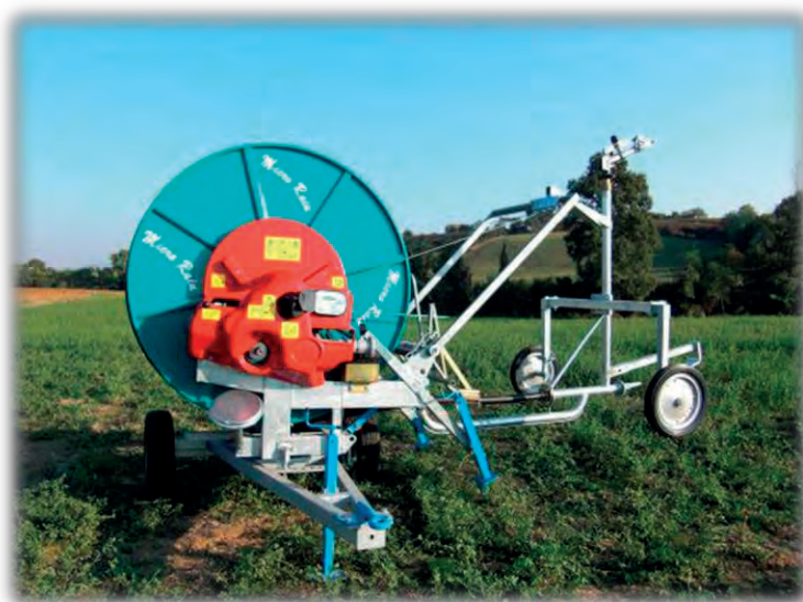
Figura 21 - Estrutura do enrolador e respetivo reboque 12 .
